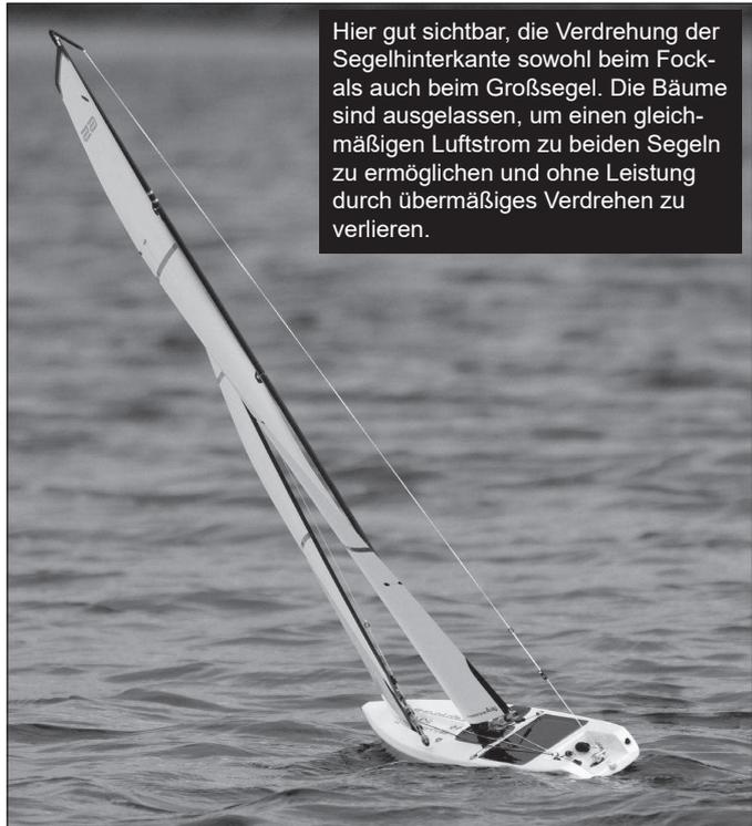
Hier gut sichtbar, die Verdrehung der Segelhinterkante sowohl beim Fock als auch beim Großsegel. Die Bäume sind ausgelassen, um einen gleichmäßigen Luftstrom zu beiden Segeln zu ermöglichen und ohne Leistung durch übermäßiges Verdrehen zu verlieren.
